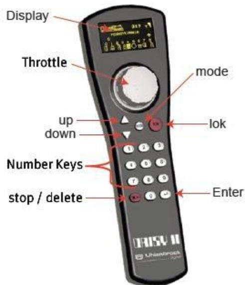
La manopola serve per impostare la velocità e la direzione e per lo stop di emergenza della locomotiva, selezionando il record dei dati della locomotiva, la posizione del simbolo e i simboli nel nome della locomotiva.
